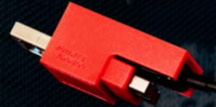
Der **Link Lock** erlaubt ausschließlich die ausgewählte Nutzung von Peripheriegeräten. Verhindert das Einstecken von nicht autorisierten USB-Geräten und das Entfernen von autorisierten USB-Geräten.
